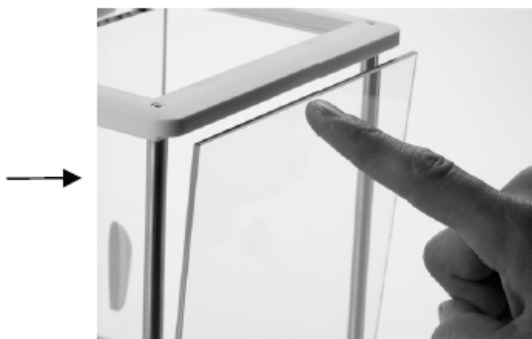
2) Установите стенки: вставьте нижний край в паз, затем прижмите верхний край до срабатывания защелки.
