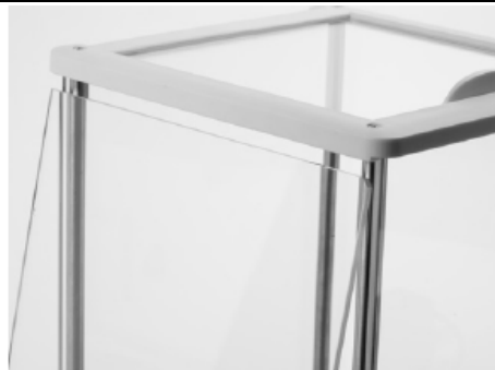
1) Установите боковые дверцы: сначала вставьте верхний край до упора в паз верхней рамки, затем заведите нижний край за направляющую.
